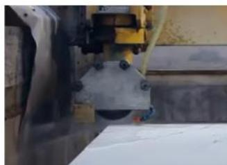
Proceso de corte con aporte de agua en sistema abierto
